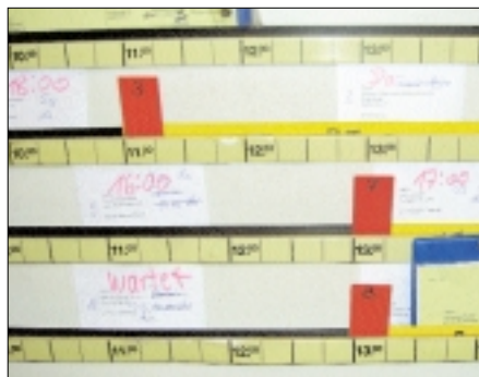
Das rote Merkkärtchen markiert, wann mit einem Werkstattauftrag begonnen wird. In der Farbe Gelb ist die geplante Dauer des Auftrages markiert. Dank der Leuchtfarben kann der Serviceberater schon von weitem überblicken, was für den Tag geplant ist.
