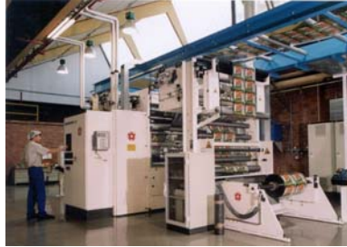
Um die Produktionsmaschinen – wie diese lösemittelfreie Kaschiermaschine – optimal auslasten zu können, ist eine vorausschauende Planung erforderlich. Bild: Amcor Flexibles
